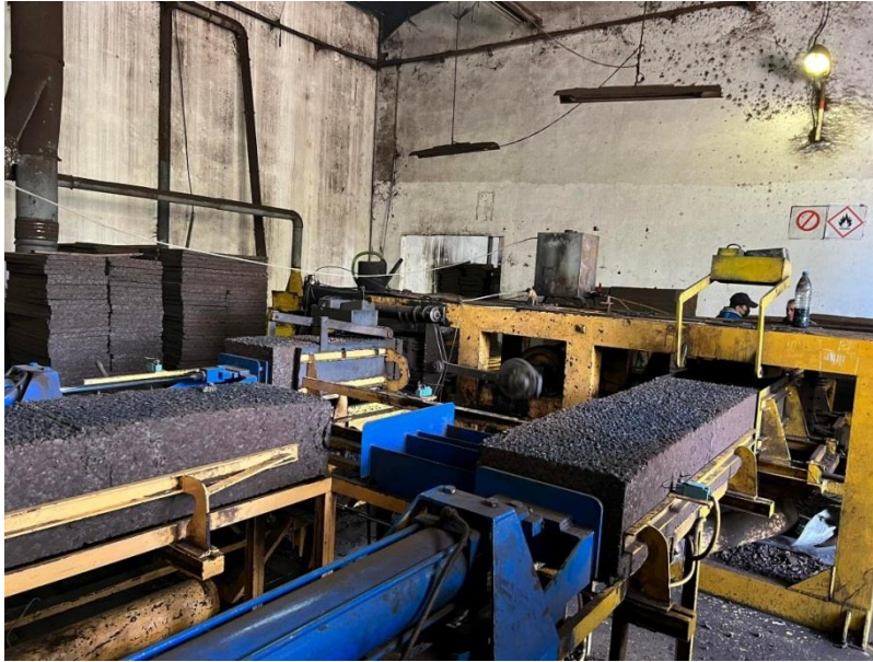
Figure II. 8 Débitage et ponçage.
