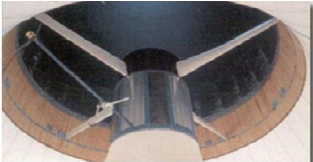
Fig. I.6. Turbine pour cheminée solaire de large diamètre [4]
