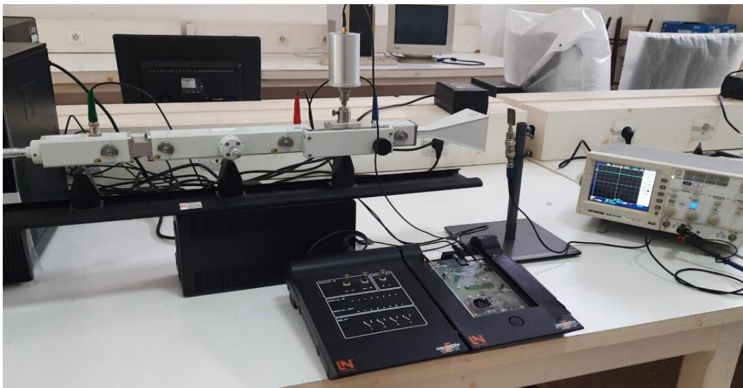
Figure III.37 : Banc de mesures de l'antenne Patch.
