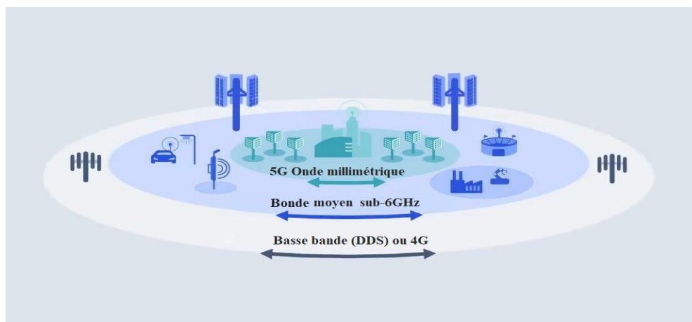
Figure I.2 : Les trois groupes de fréquences utilisés par la 5G
