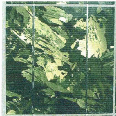
Figure I.14: Une cellule photovoltaïque poly-cristalline
