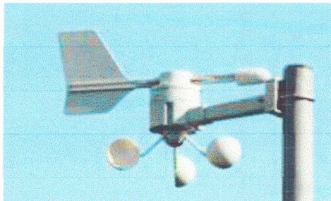
Figure II.11 : la girouette et l'anémomètre.
