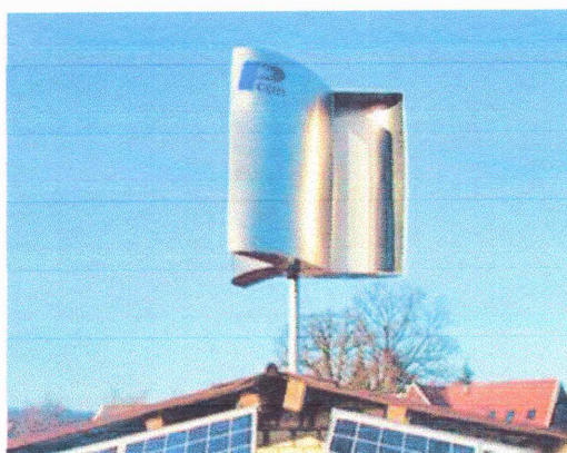
Figure I.3 : Éolienne verticale Savonius.
