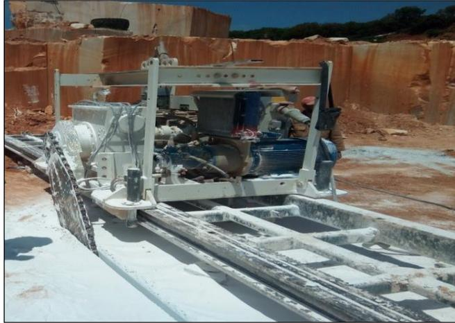
*Fig.V.3- Haveuse (machine d'abattage)*
