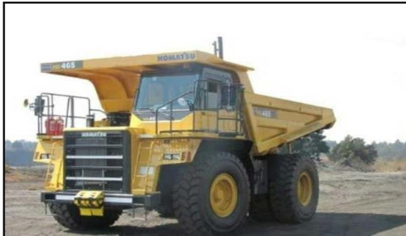
*Fig.V.16- dumper pour le transport (Camionkomatsuhd465-7).*
