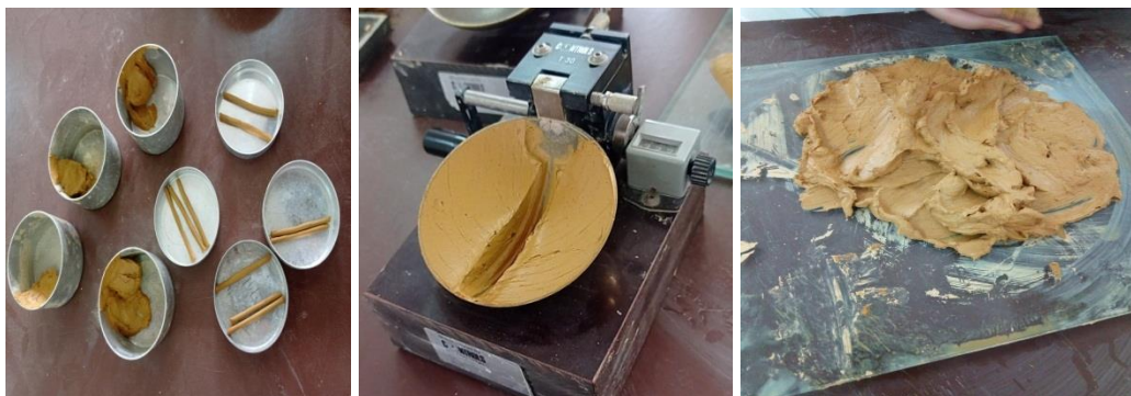
Figure III.5. Détermination des limites d'Atterberg (NF P 94-051)
