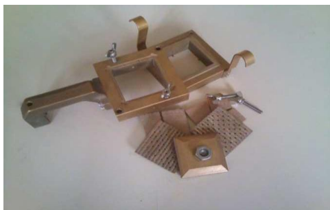
Figure III.20. Les constituants de boîte de cisaillement
