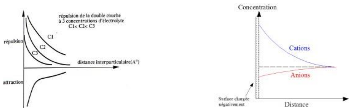
Figure II.12. Forces électrostatiques dans la double couche, répartition des ions autour d'une particule chargée.
