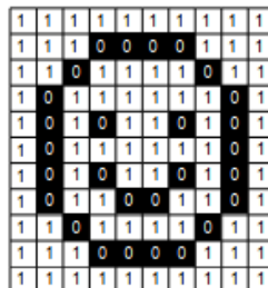
FIGURE 1.7 – Exemple d'une image binaire [16]
