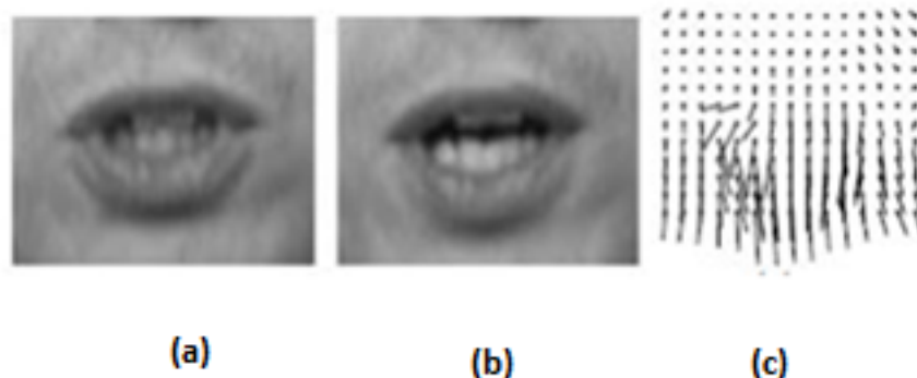
FIGURE 2.5 – : Flux optique. (a et b) Région de la bouche sur deux images consécutives. (c) Champ de vecteur de vitesses.
