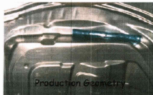
Fig.I.10 Le processus de reformage électromagnétique appliqué sur le panneau de porte.
