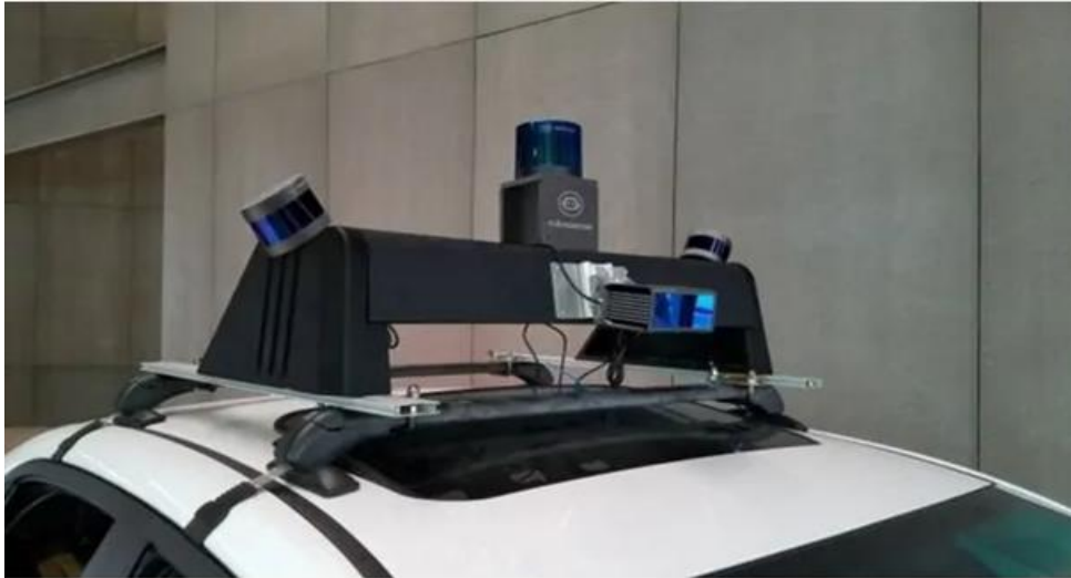
Figure 2.9 : La technologie lidar appliqué sur voiture [17].
