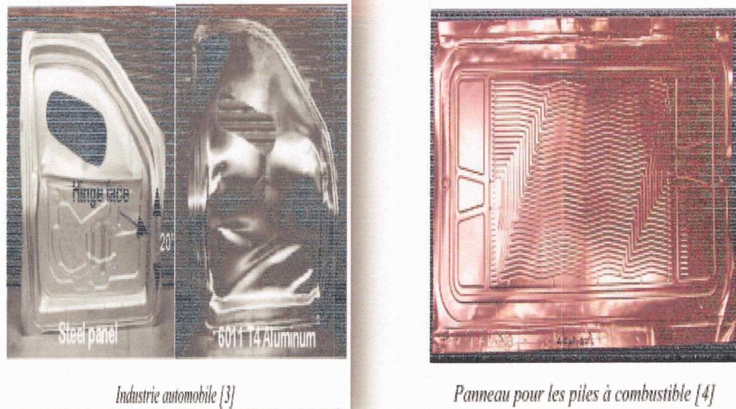
**Figure I-15 :** Panneaux de porte d'automobile, démonstration de formage [14]
