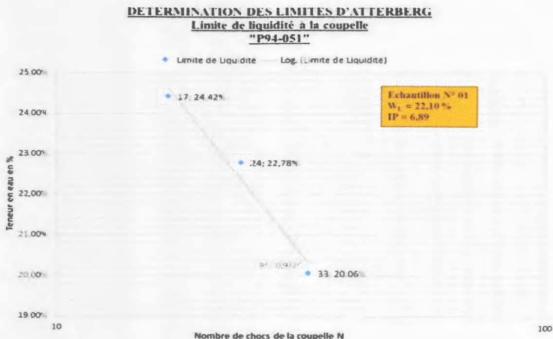
Fig.III.6. Détermination de la limite de liquidité échantillon (P01-E01).
