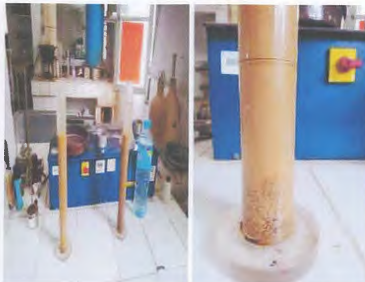
Fig.III.3. Exemple de l'essai équivalent de sable.
