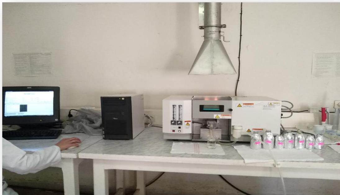
**Photo 15** : Spectromètre d'absorption atomique
