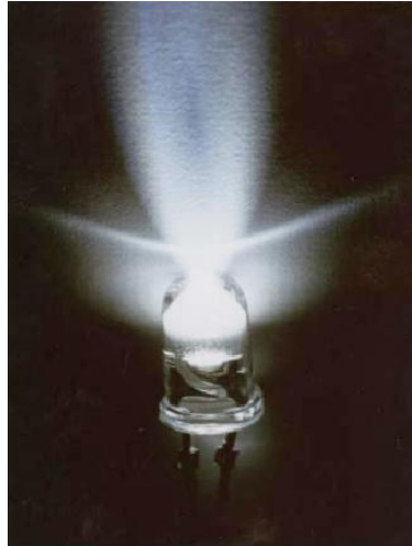
Figure I. 17. Photographie d'une diode blanche réalisée à partir d'une diode bleue et de YAG:Ce 3+ .
