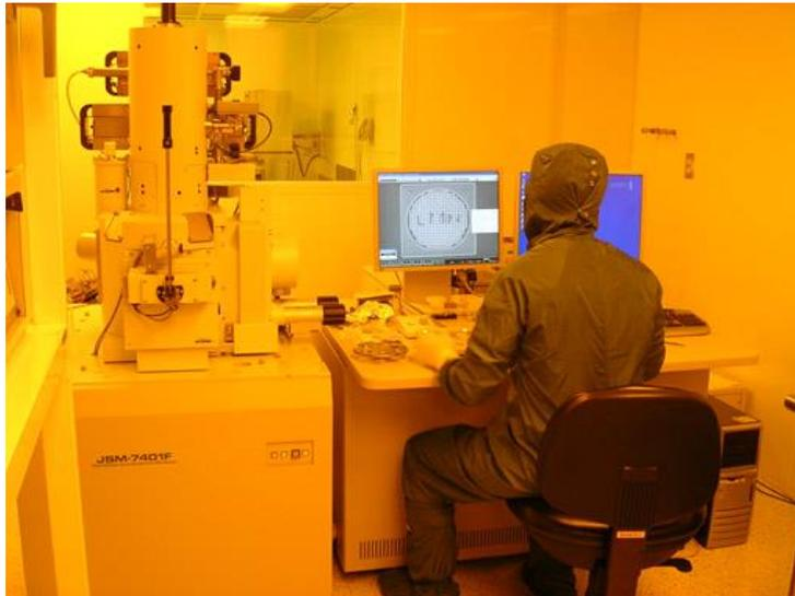
**Figure II. 15.** Microscope électronique à balayage modèle Jeol JSM-7401F (LMN).
