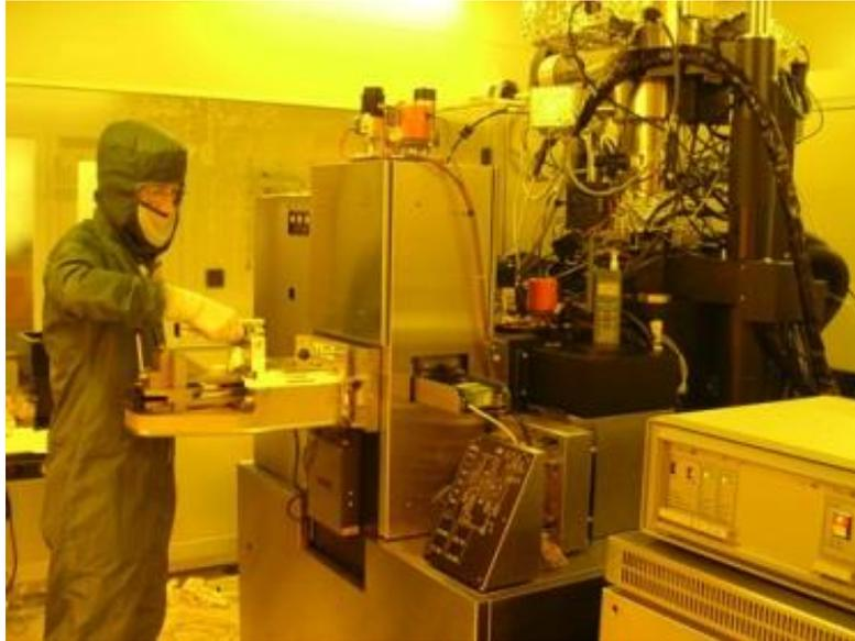
**Figure II. 2.** Photo de VB6 UHR EWF installée en zone lithographie de la salle blanche du LMN.
