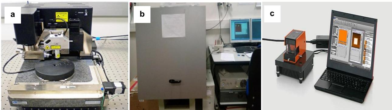
Figure II. 17. Microscopie à force atomique. (a) D3100 Bruker ; (b) Digital Nanoscope Dimension 3100 ; (c) Nanosurf easyScan 2.
