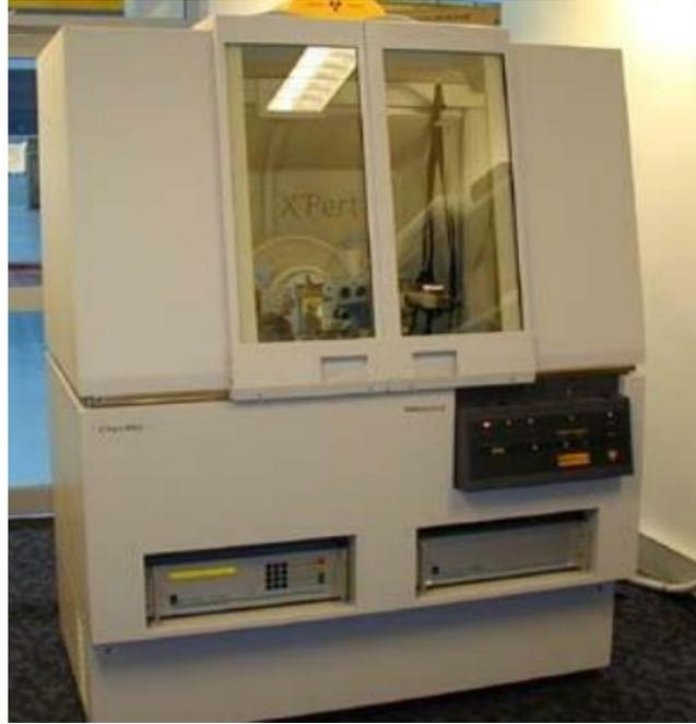
**Figure II. 12.** Diffractomètre X'pert pro Pan-Analytical.
