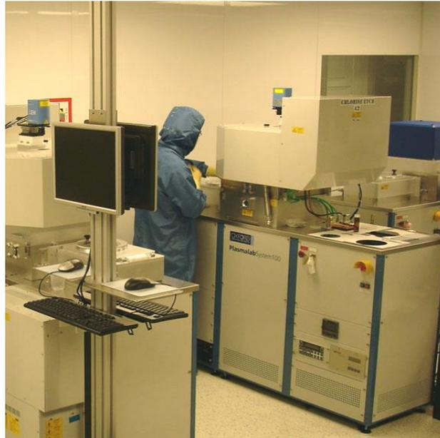
**Figure II. 10.** Photographie du bâti de plasma RIE model Plasmalab 80 Plus d'Oxford (LMN-INRS).
