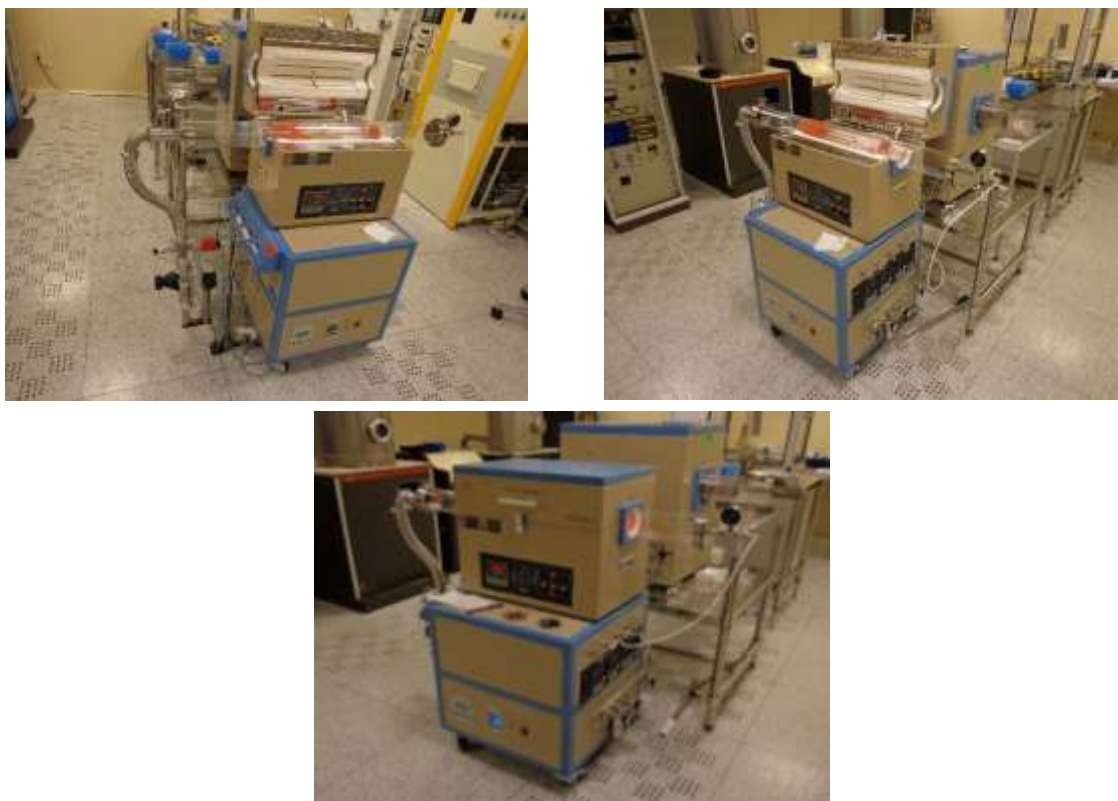
Figure 3.8. Four CVD tubulaire à écoulement horizontale et à paroi chaude utilisé dans le cadre de notre étude pour la synthèse du graphène.
