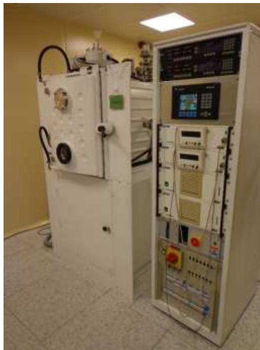
Figure 3.25. Image du métalliseur VACOTEC.
