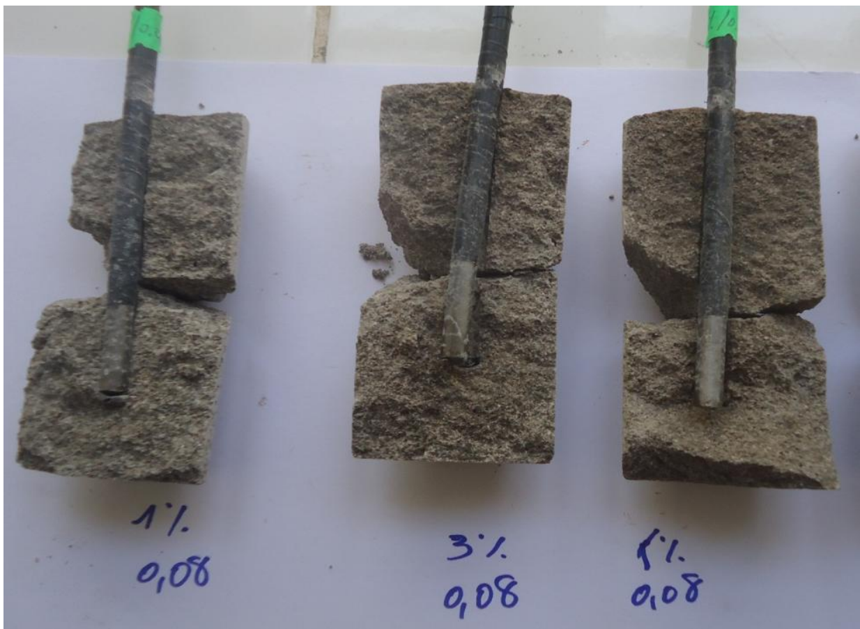
Figure III.39. Macrographies traduisant l'état de l'acier après immersion de 8 jours dans la solution 3%NaCl : Granulométrie = 0.08 mm
