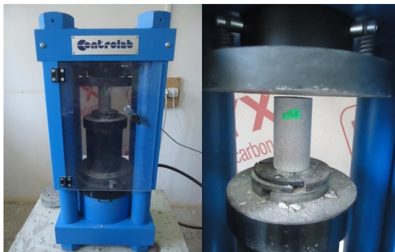
Figure II.10. Presse hydraulique modèle CONTROLAB
