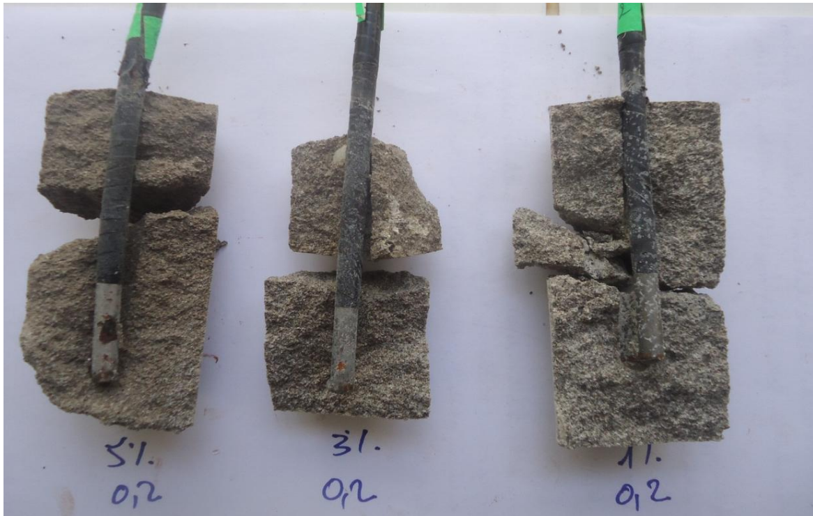
Figure III.40. Macrographies traduisant l'état de l'acier après immersion de 8 jours dans la solution 3%NaCl : Granulométrie = 0.2 mm
