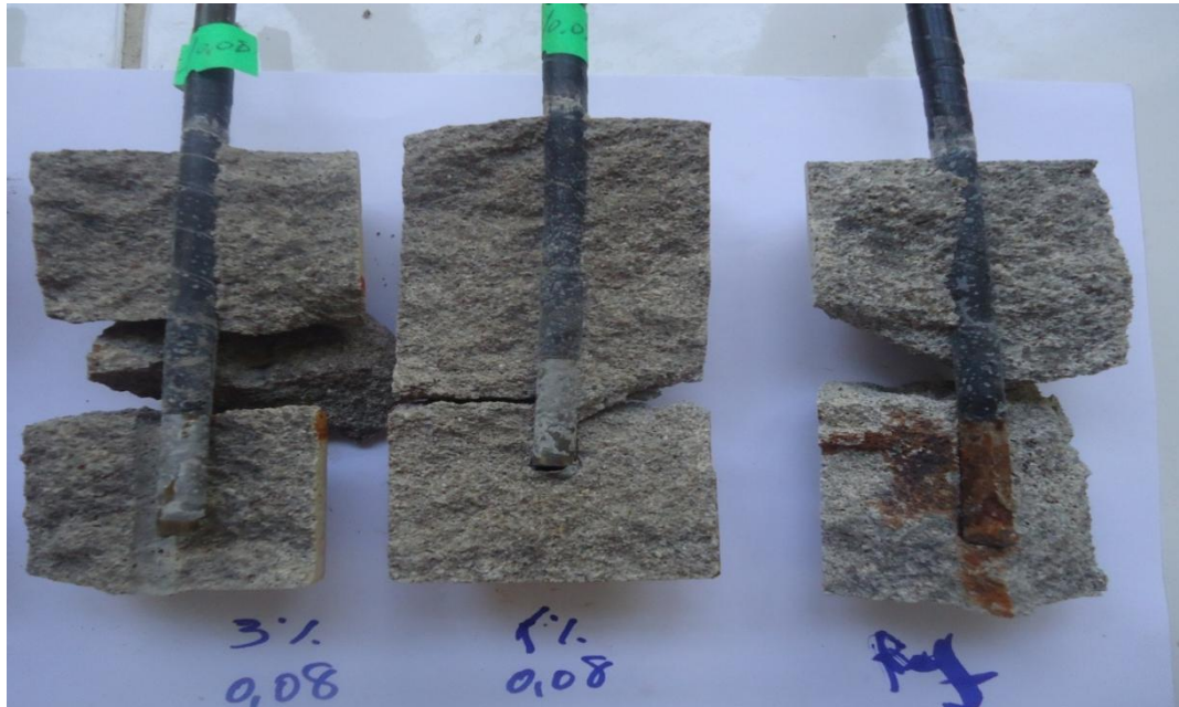
Figure III.41. Macrographies traduisant l'état de l'acier après essai de corrosion accélérée:
