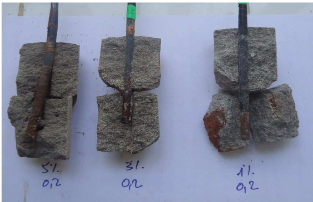
Figure III.42. Macrographies traduisant l'état de l'acier après essai de corrosion accélérée :
