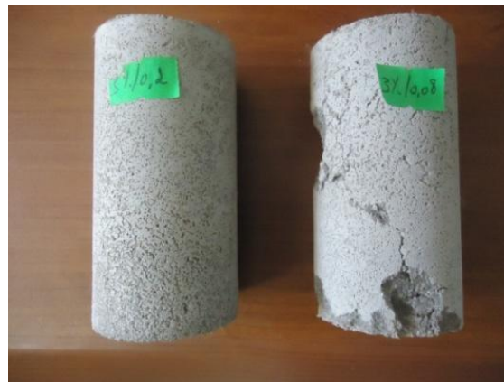
Figure III.38. Photographies des spécimens avant et après écrasement dans la presse.
