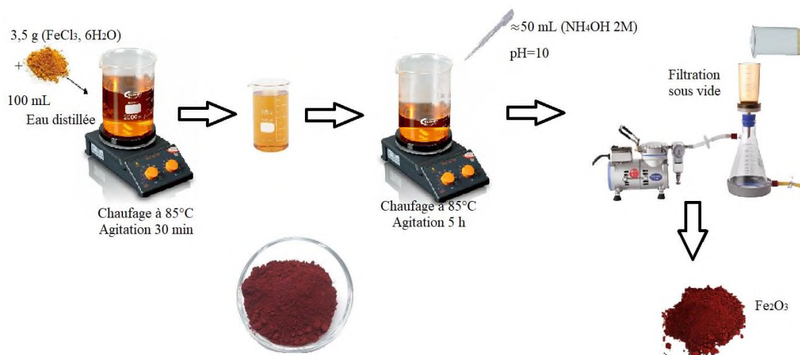
Figure IV.5 : Protocole expérimental pour l'élaboration de Fe 2 O 3 .
