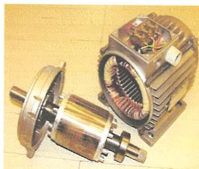
Figure. I.11 Rotor (à gauche) et stator (droite)
