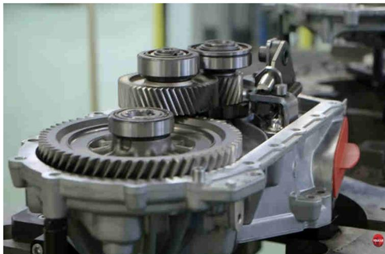
**Figure II.12 :** Bloc réel de transmission d'un véhicule électrique
