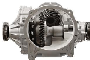
**Figure II.10 :** Bloc mécanique réel d'un différentiel
