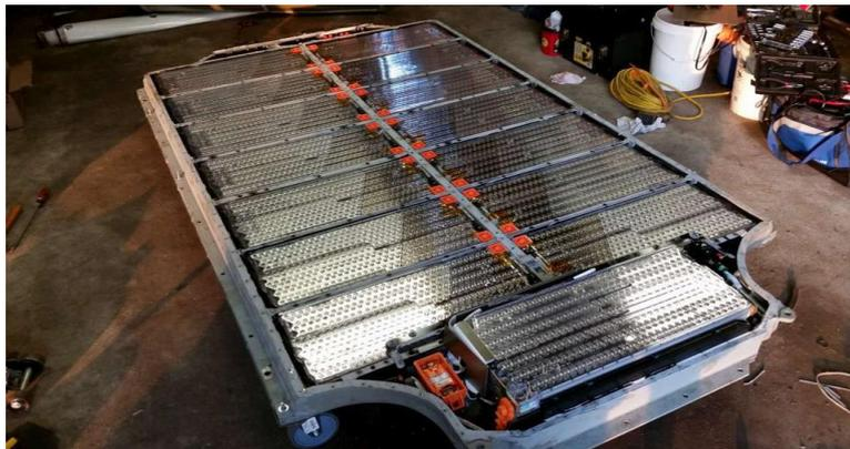
**Figure I.13 :** Exemple de batterie Lithium-Ion d'un Véhicule électrique.
