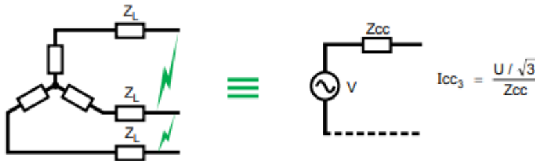
Figure III.1 Courants de court-circuit en défaut triphasé [12].
