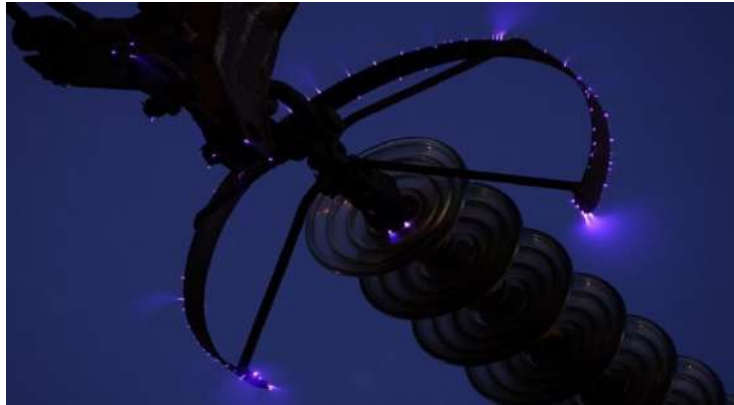
Figure I.5. Effet de couronne sur un éclateur.
