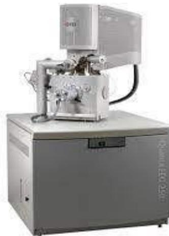
**Figure II.4 :** microscope électronique à balayage **Thermo Fisher (EX FEI)**
