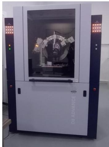
**Figure II.2** : Diffractomètre de rayon X **D8 ADVANCE- Bruker**
