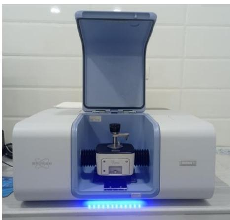
**Figure II. 3 : Spectroscopie infrarouge INVENIO R- Bruker**
