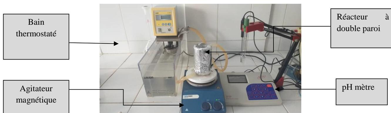
**Figure II.6.** Montage expérimentale utilisé pour la dégradation de Mag
