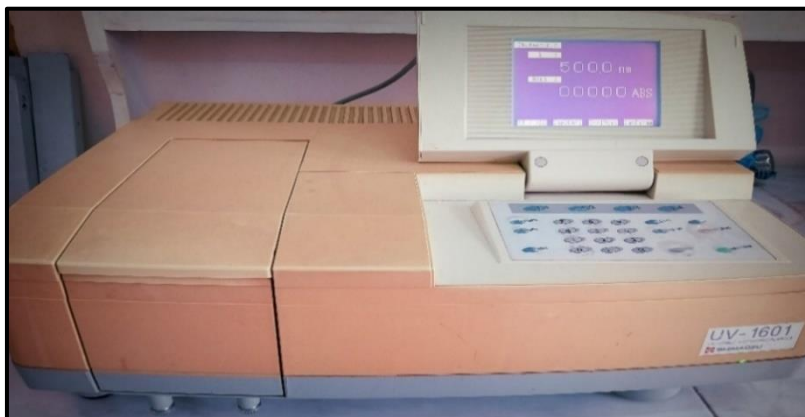
Figure II.3 : L'image de l'appareille de spectrophotomètre UV-visible
