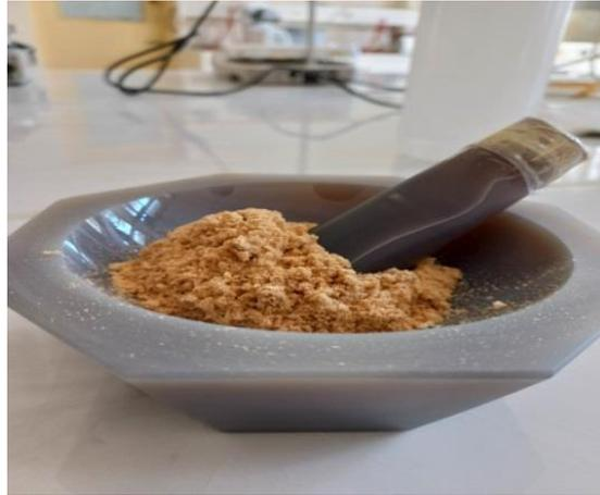
**Figure II. 3 :** Opération du broyage dans un mortier en agate.
