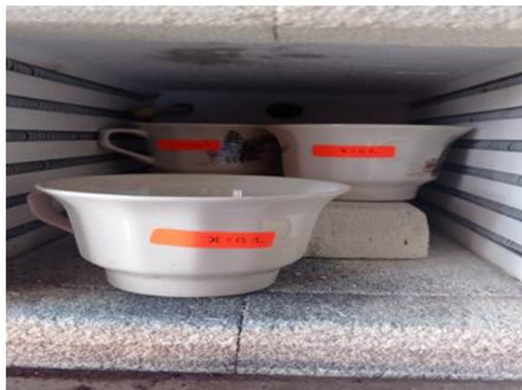
**Figure II. 4 :** Opération de calcination dans un four de traitement thermique.
