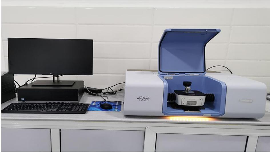
**Figure II. 11 : Spectromètre FTIR-ATR**
