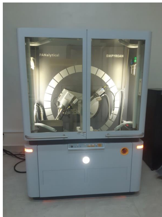
Figure II.5 : Photo de l'appareillage utilisé pour diffracter les couches élaborées.
