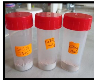
Figure II.3. Les échantillons après le rebroyage.
