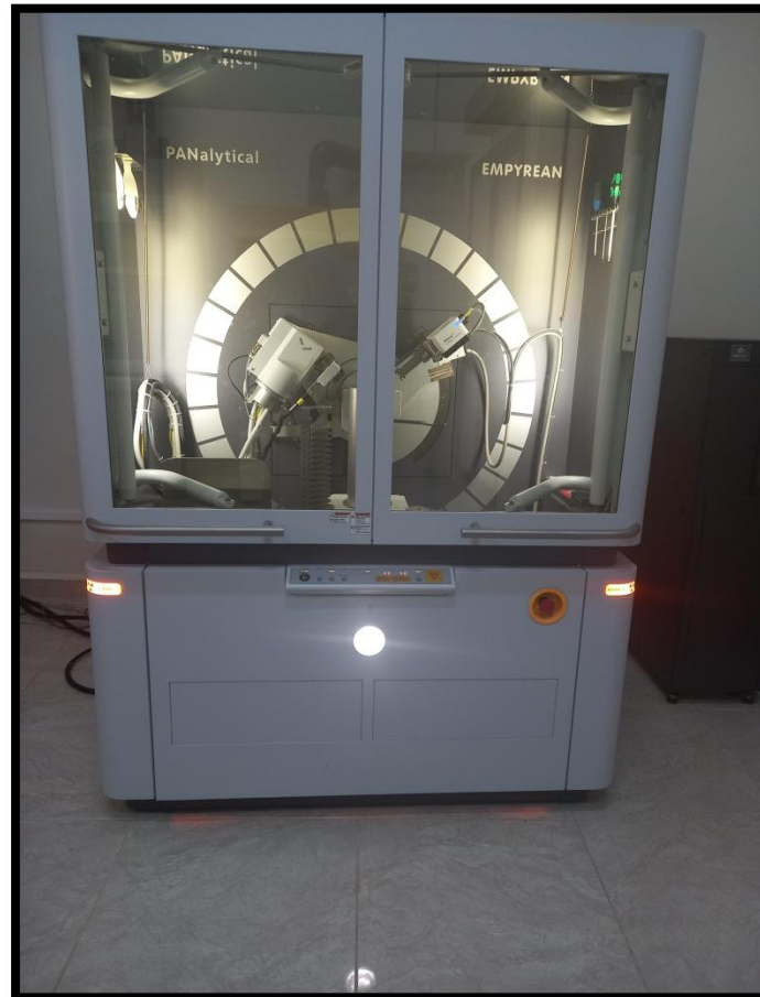
Figure II.5. Diffractomètre à Rayon X (Marque Empyrean PANalytical, CRAPC de Bejaia).
