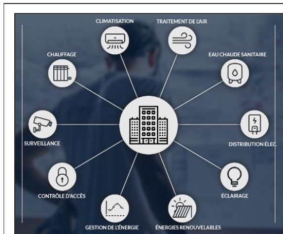
Figure 41 : La GTB Source : CSP Group (2023)
