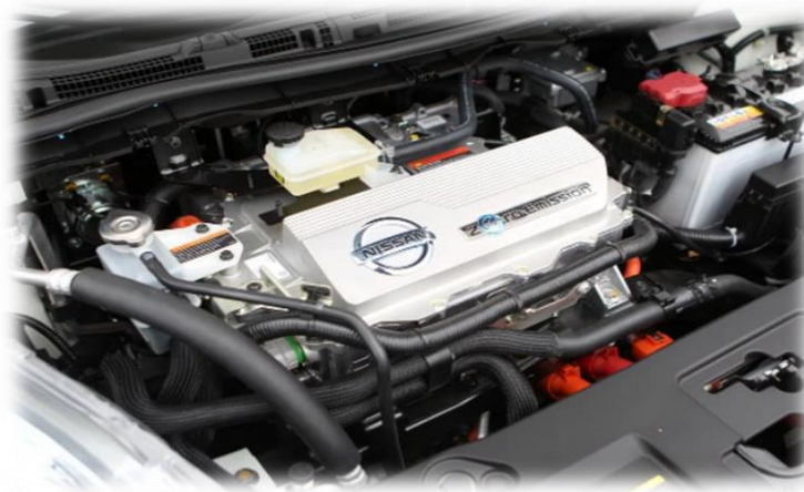
Figure I.6 : Convertisseur d'un véhicule électrique [12].
