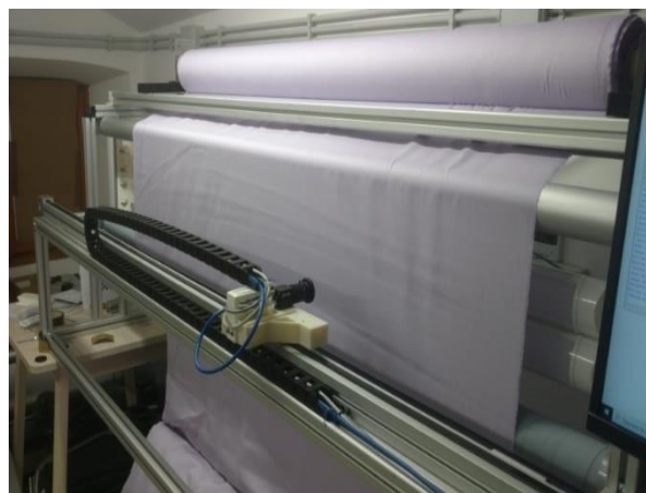
Figure (I.7) : Exemple de système d'inspection automatique.
