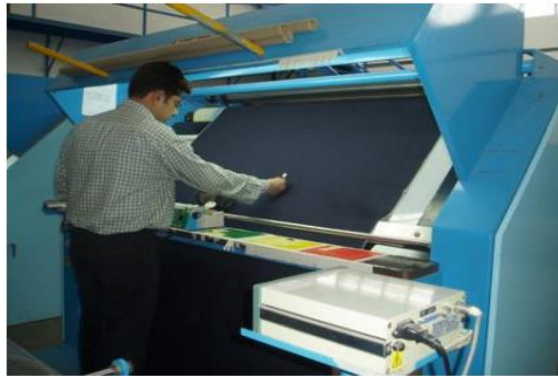
Figure (I.6) : Systèmes d'inspection basés sur l'homme.
