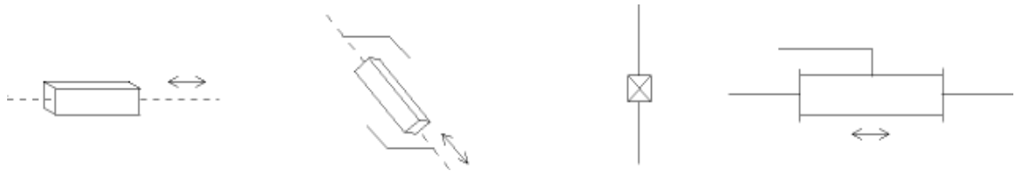
Figure I.4 Symbole de l'articulation prismatique.
