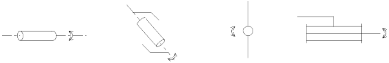
Figure I.3 Symbole de l'articulation rotative.
