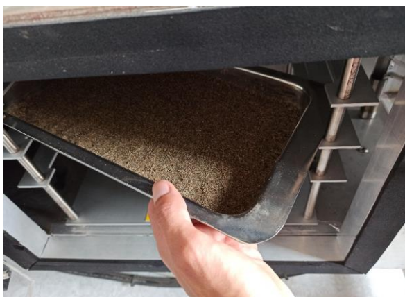
Figure II.7. Placement du bol en métal dans l'unité de séchage
