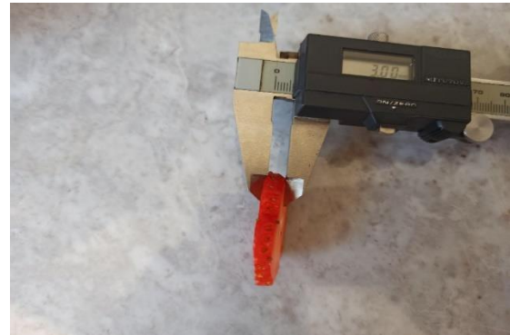
Figure II.11. L'échantillon du frais à 3mm
