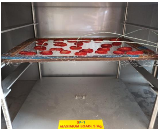
Figure II.12. La position des captures de température
