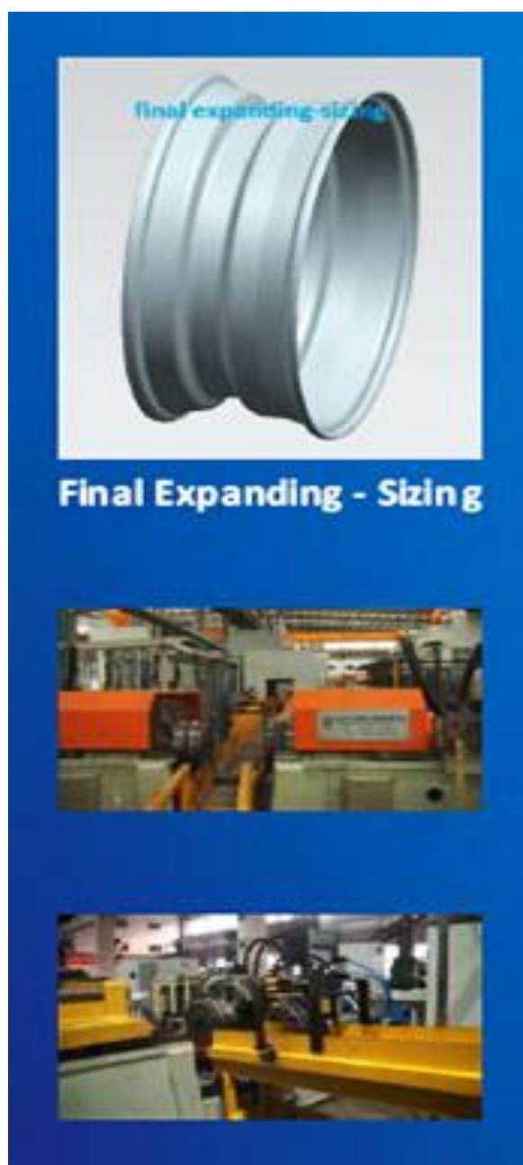
Figure II.7 : Formage final par laminage [2].
