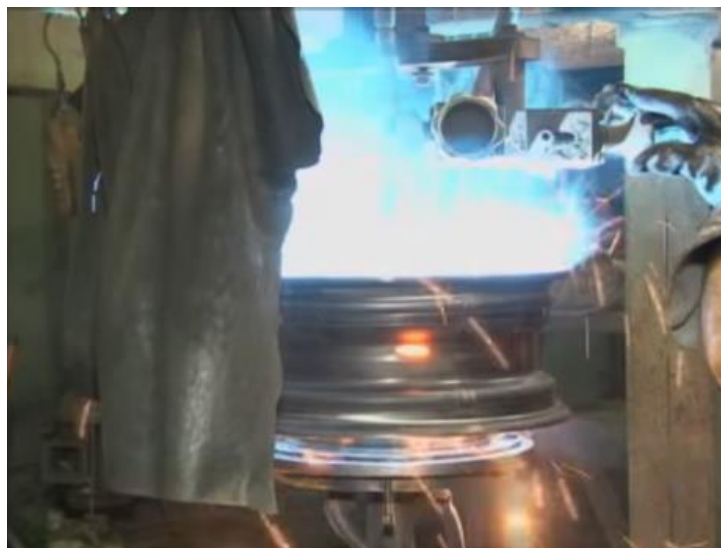
Figure II.13 : Soudage Mig-Mag du disque à la jante [1].
