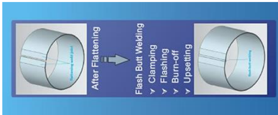
Figure II.3 : Conception de tôles d'acier soudées et conformées [2].
