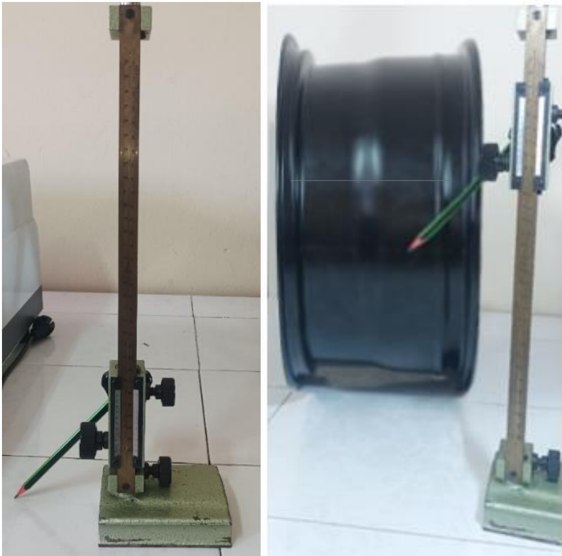
Figure III.2 : Traçage d'une ligne sur le profil de la jante à l'aide du trusquin.
