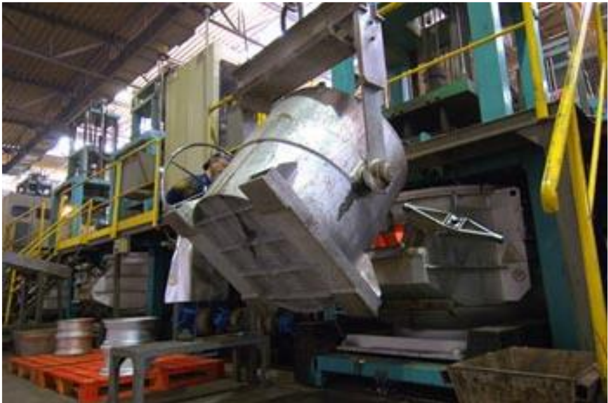
Figure II.17 : Opération de coulée d'alliages de jantes [4].
