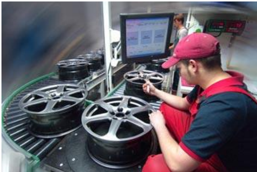
Figure II.22 : Contrôle de la qualité des jantes en alliage [3].
