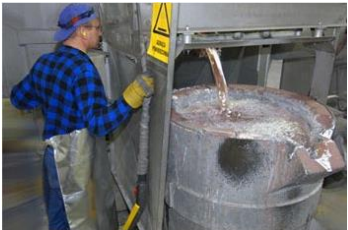
Figure II.16 : Remplissage du creuset par le laitier de coulée [4].
