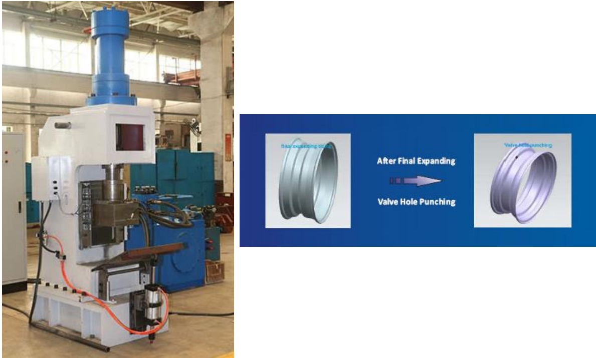
Figure II.8 : Poinçonnage du trou de la valve [2].
