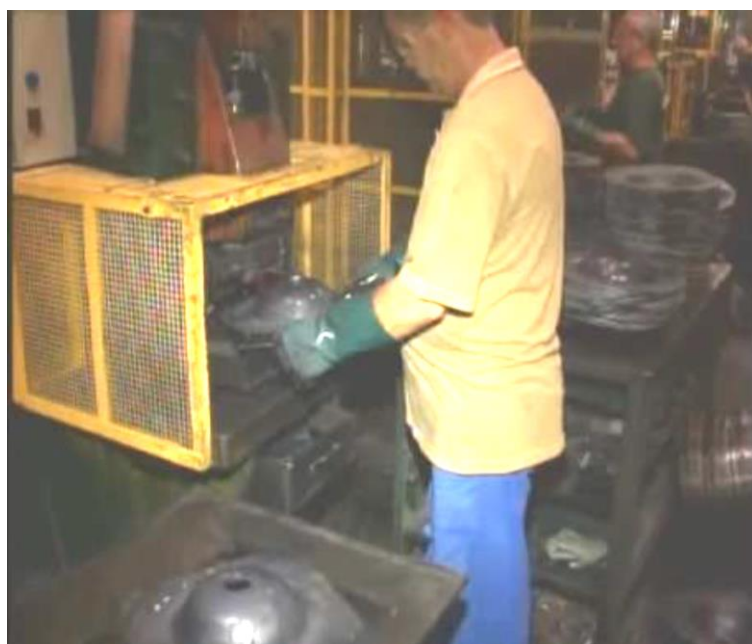
Figure II.10 : Perçage des disques [1].
