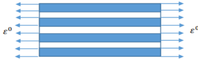
Figure II.8. Direction utilisée par la limite Voigt pour calculer la rigidité du composite.
