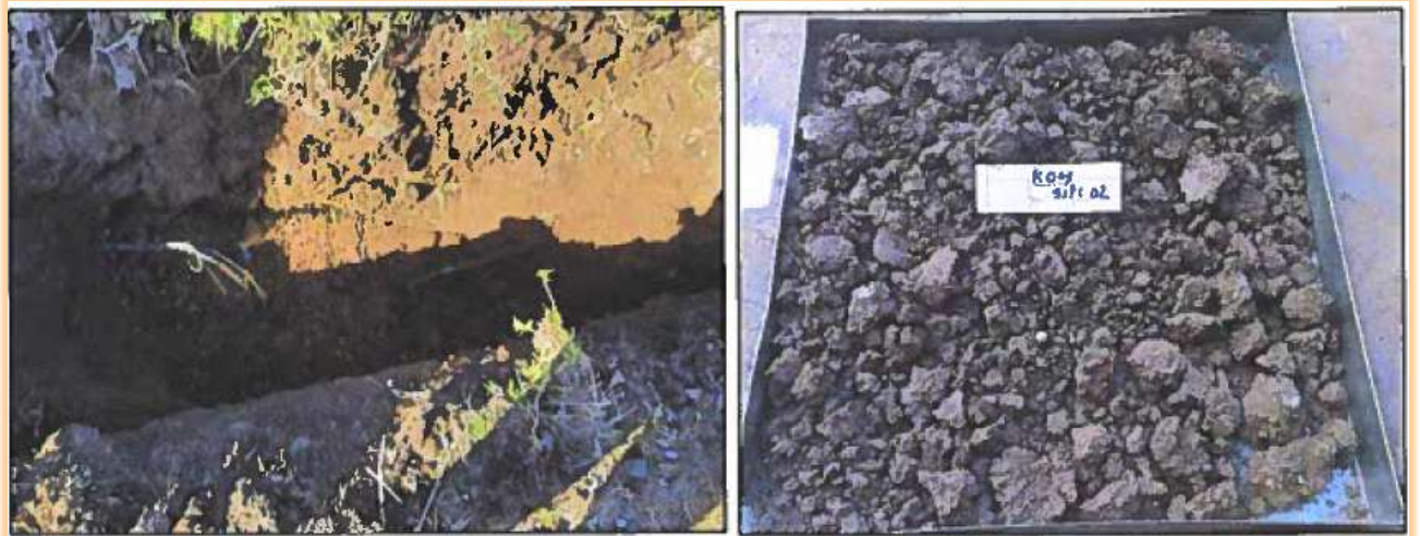
Puits N° PK 2+100 Argile limoneuse légèrement sableuse. [18]
