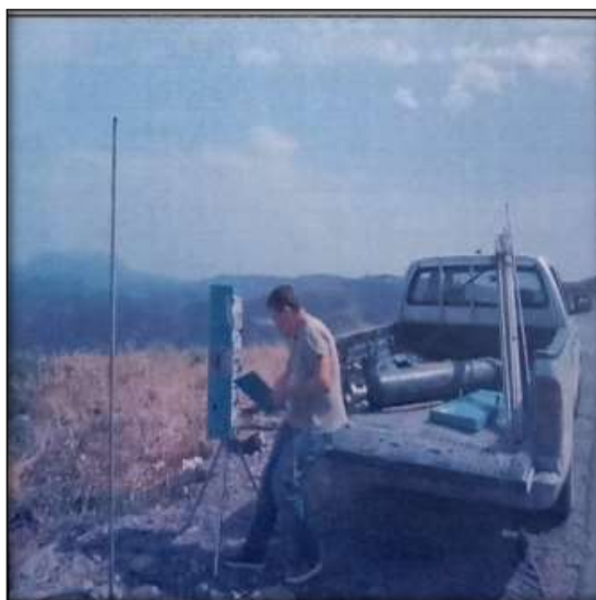
Figure III.11: Implantation d'un point de sondage pressiométrique.
