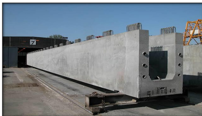
Figure II.15: Exemple de réalisation d'une poutre en béton.
