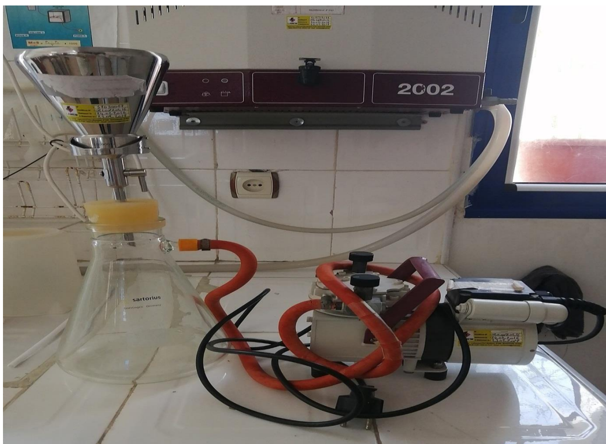
Figure III.6 : filtration sous vide
