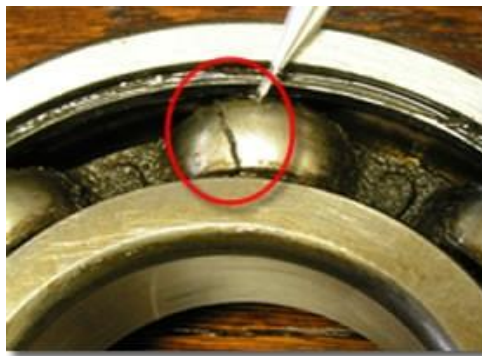
Figure I.12 : Défaut de cage à bille [2].
