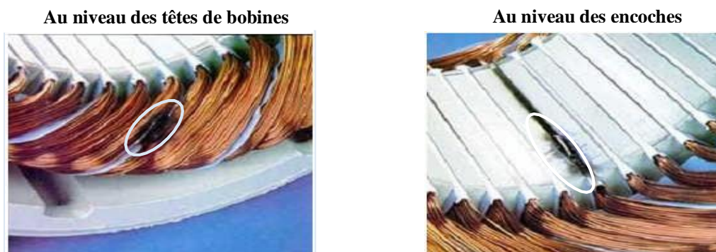
Figure I.10 : Défaut de court-circuit entre spires [3].
