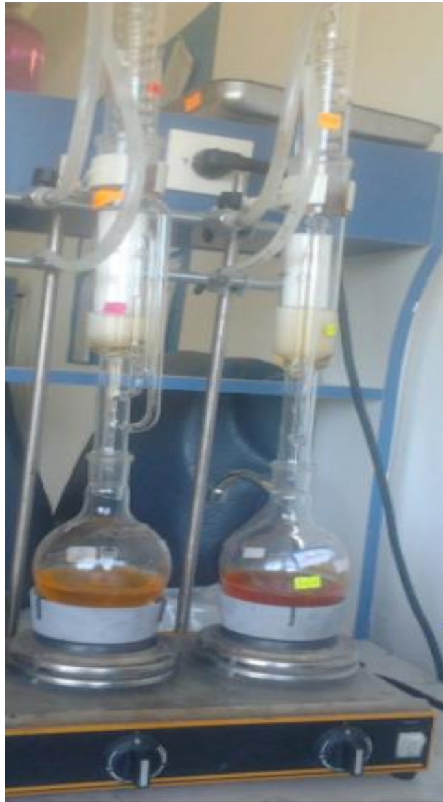
Figure 5 : Etape d'extraction conventionnelle par soxhlet
