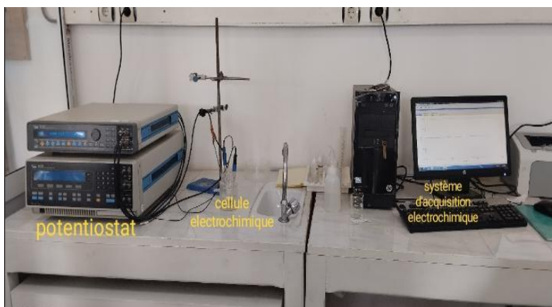
Figure II.8: Dispositif expérimental pour les tests électrochimiques
