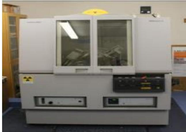
**Figure II.2:**Le diffractomètre XPERTPRO utilisé pour l'enregistrement de diffractogrammes
