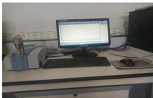
**Figure II.5:** spectromètre IR à transformée de Fourier
