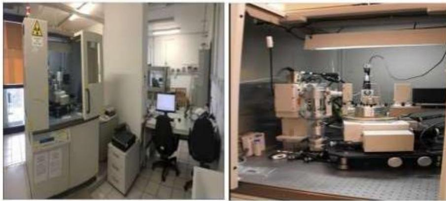
**Figure I. 6 :** Diffractomètre de diffraction X sur poudre [23]
