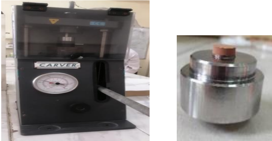
Figure II.2 : Illustration et image de la presse unie axiale à froid utilisée pour le compactage de la poudre.
