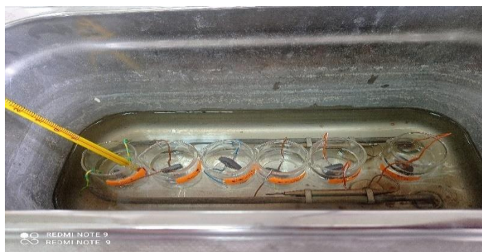
Figure II.2 : Dispositif expérimental utilisé lors des mesures gravimétriques
