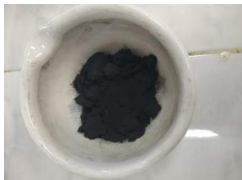
Figures II-3 : Broyage et calcination de l'eucalyptus
