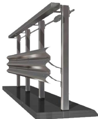
Figure 11.8. Dispositif de retenue.
