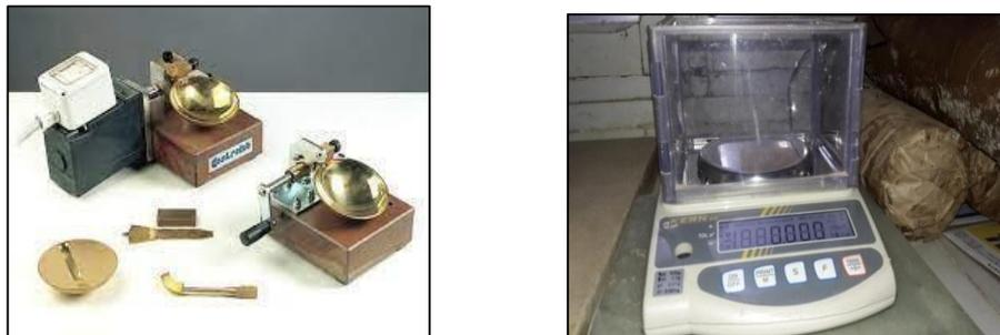
**Fig. 10.** Appareillages et outils pour la mesure des limites d'Atterberg
