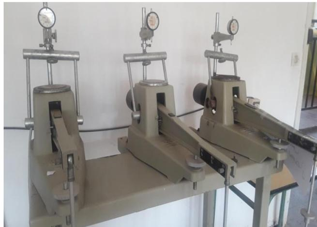
**Fig.14.** Essai de la compressibilité à l'œdomètre
