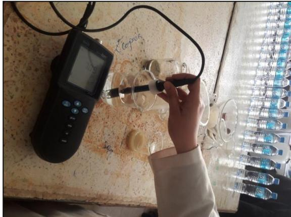
**Fig. 7.** Mesure de pH (pH-mètre)
