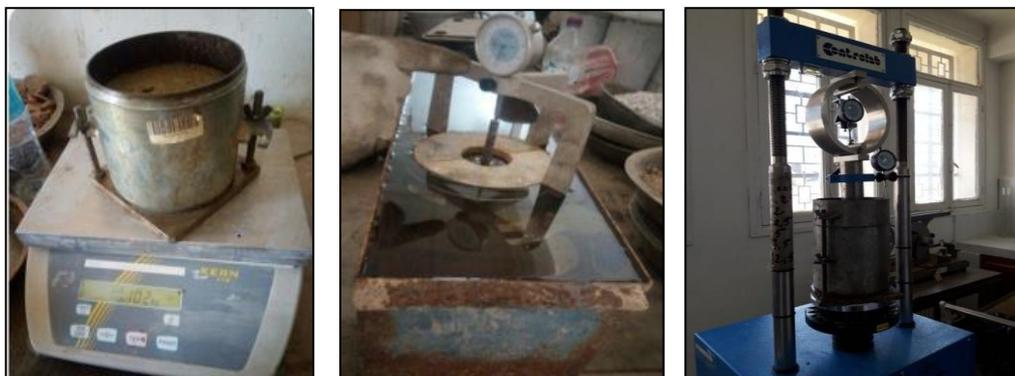
**Fig. 15.** Appareil de CBR
