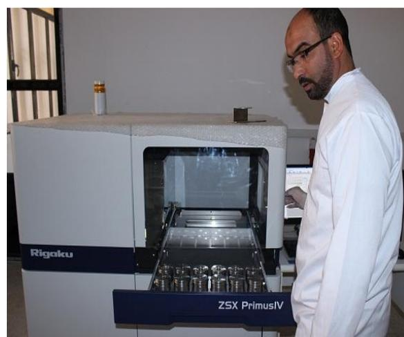
**Fig. 17.** Spectrométrie de fluorescence par les rayons X (Unité de recherche matériaux émergents, Sétif).
