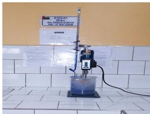
**Fig. 11.** Essai au bleu de méthylène
