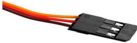
**Figure II.13** : Câble servomoteur [10].
