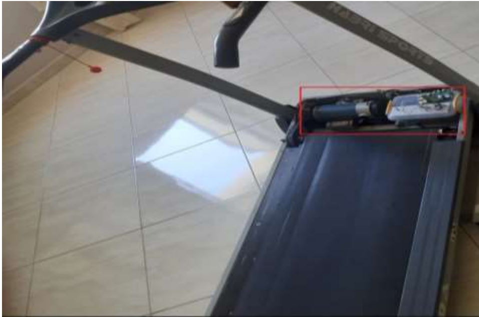
Figure 2.31 Intégration de la console de commande avec le tapis de course
